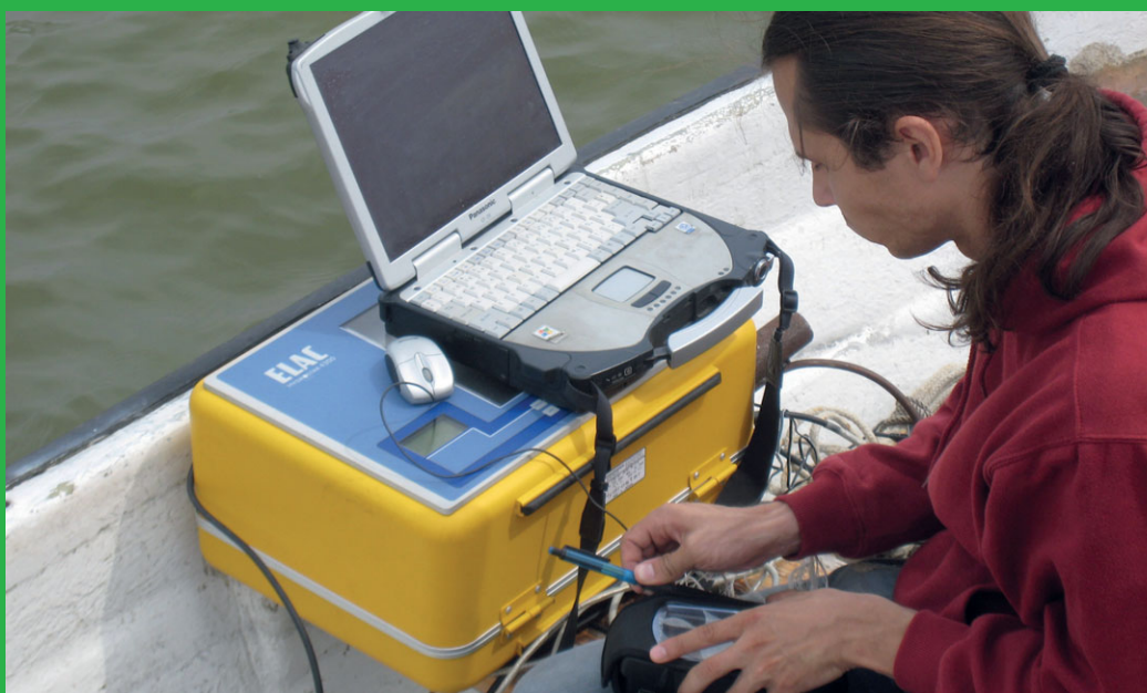
Jūros dugno tyrimai vienspinduliniu echolotu
